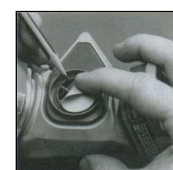
檢視閥片基座是否有外物阻塞或閥片有變質、磨損與破裂。
