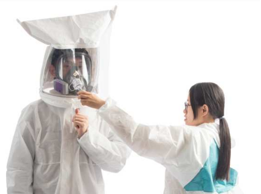
全面體呼吸防護具之定性密合度測試
