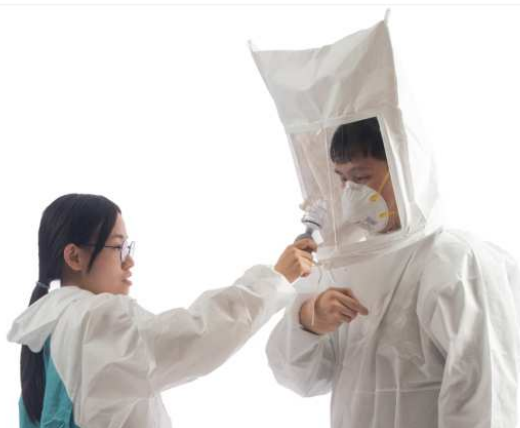
過濾面體式口罩之定性密合度測試
