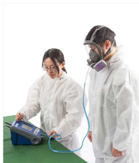
以儀器量測方法進行全面體呼吸防護具之定量密合度測試
