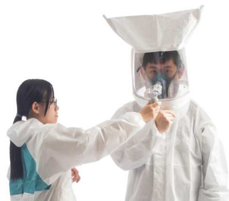
半面體呼吸防護具之定性密合度測試
